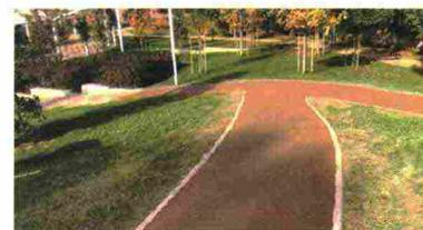
nel terreno, evitando ristagni, ma è anche fonoassorbente, resistente al fuoco, al gelo e agli idrocarburi. Viene posato a freddo, evitando fumi nell'aria, e se addizionato con ossidi nei colori delle terre è utilizzabile in zone con vincoli ambientali o paesaggistici.
